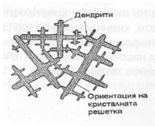
Фигура 10 Схема на образуване на дендритна структура
