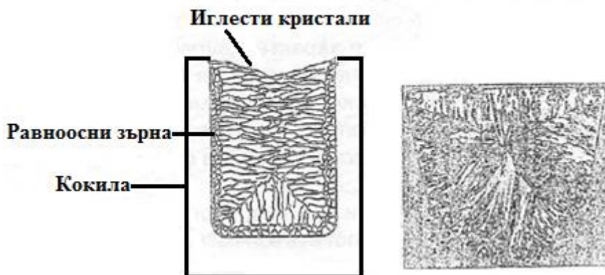
Фигура 11 Схема на образуване на дендритна структура
