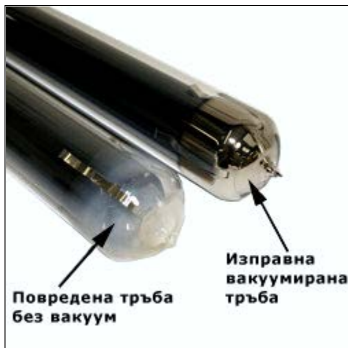
Фиг.4 Повредена и изправна вакуумна тръба.
