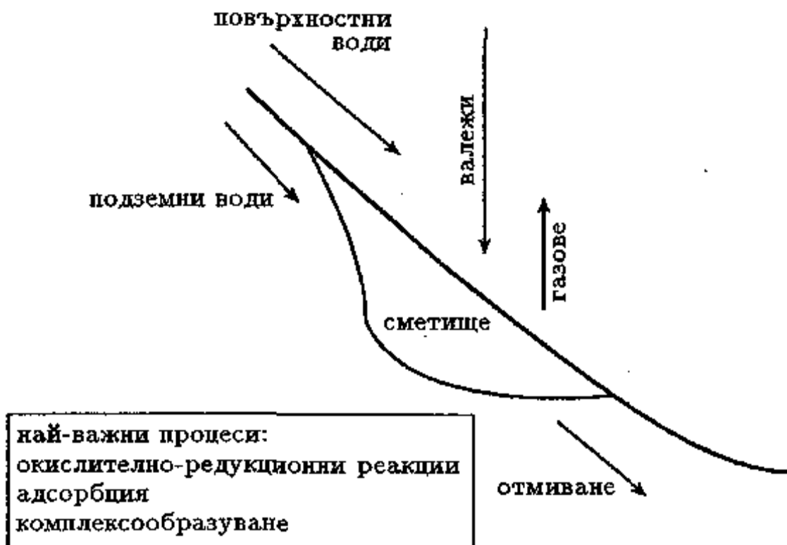
Фиг. 1. Схема на входните и изходните масови потоци в сметище
