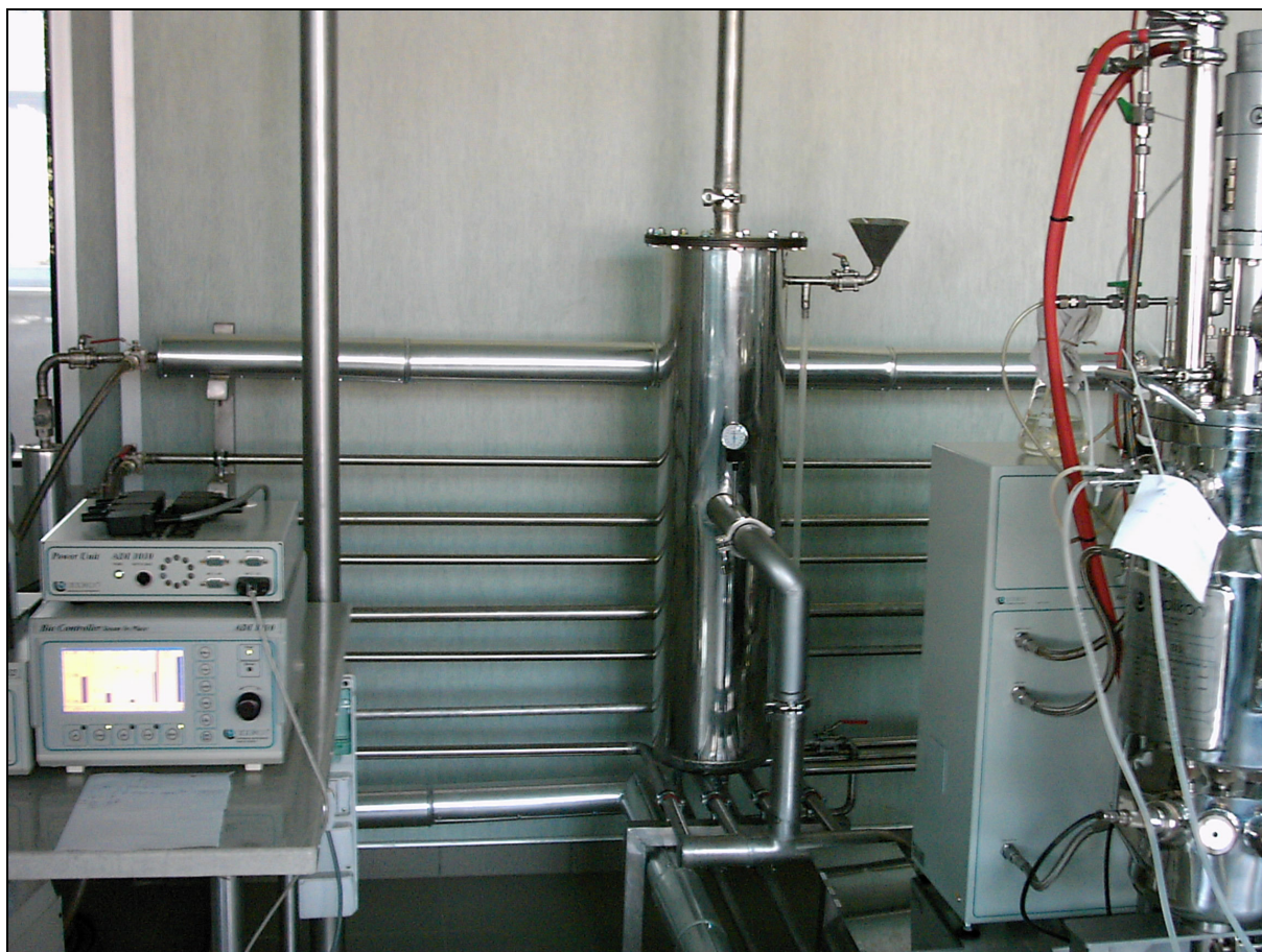
Фиг. 2. Монтиране на филтър с циклон, тип „Скрубер“ в био-инженерната лаборатория на “БИОВЕТ”, гр.Пещера.
