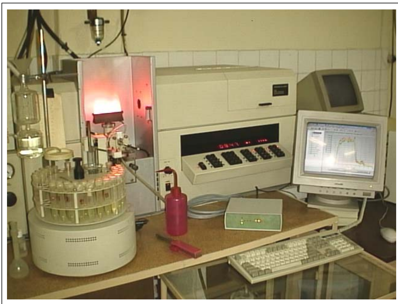
Фигура 14. Снимка на системата ASDI – FAAS в режим на работа.
