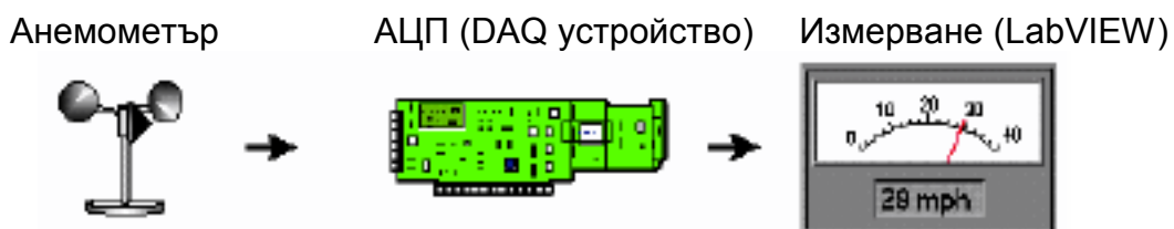
Фиг. 3.45. DAQ система за измерване скоростта на вятъра
