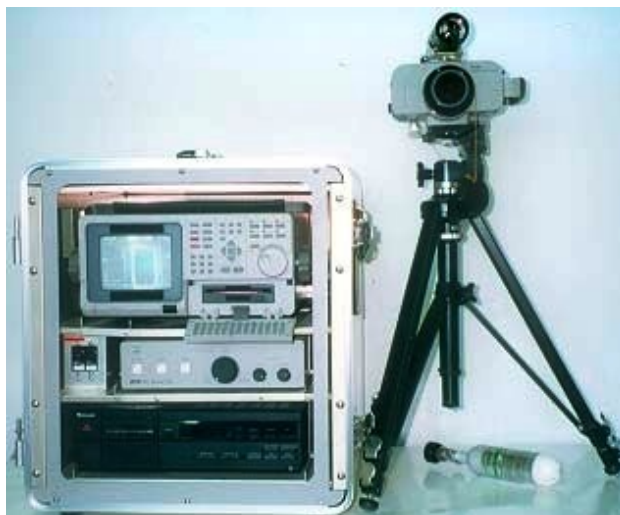
Фиг. 4.3. Инфрачервена камера за дистанционно наблюдение и измерване на температурата на повърхности. Прилага се за определяне на неравномерни температурни полета на повърхността на обекти (сгради, пещи, машини)
