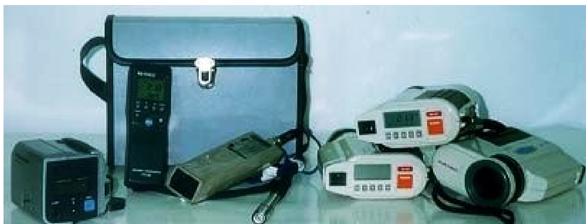
Фиг. 4.2. Инфрачервени термометри (радиационни пирометри) за дистанционно измерване на температурата на повърхност. Определят температурата на базата на енергията, излъчвана от тялото.
