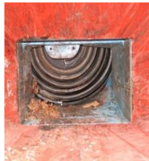
Поглед в раздробяващото устройство на винтова дробилка ©greengain
