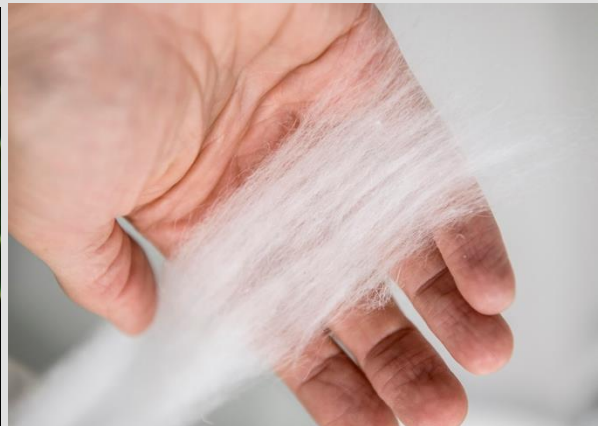
Микрофибрилирана целулоза, смесена с вода и устойчиви нишки на Spinnova © Spinnova
