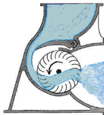
Фигура 13: Принципна схема на турбина с напречен поток (още „Банки“, „Митчел“, „Осберггер“, англ.: cross-flow)
