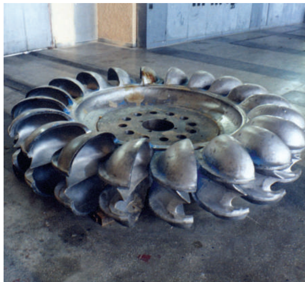
Фигура 7: Работно колело на турбина „Пелтон“ (ВЕЦ „Лиляново“)
