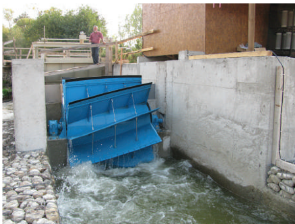
Фигура 23: „(Хидростатичната) напорна машина” – прототип на р.Искър, поглед от долу
