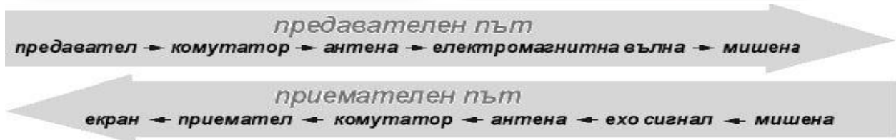
Фигура 24. Принцип на работа на радарните установки
