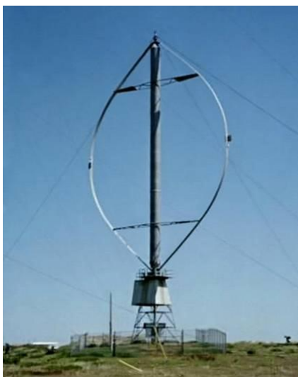
Фиг. 3 .А– Ветрогенератор с вертикална ос
