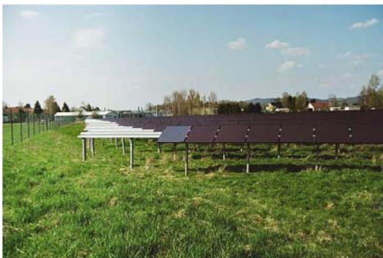
Фиг. 11: Фолиото рефлектира по различен начин в сравнение със съседните модули без фолио и различно спрямо в ляво разположените метални шини на постаментата. Западно от оградата се намира водоем със стоящи води.
